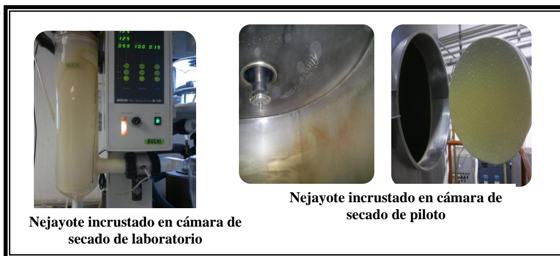
Figura 5. Cámaras de secado de los equipos utilizados mostrando la presencia de producto adherido a sus paredes.
