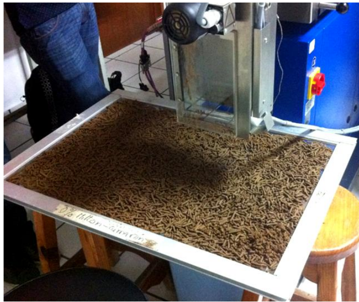
Figura 3. Alimento elaborado en el extrusor de doble tornillo TSE 20/40
