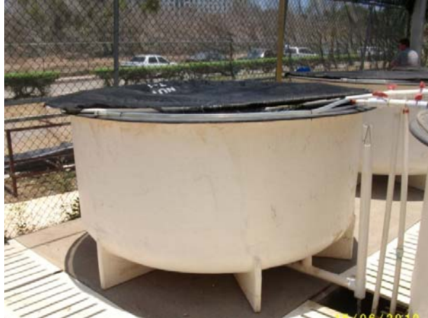
Figura 11. Tanques de fibra de vidrio de 3000 litros utilizados durante la segunda fase del experimento.
