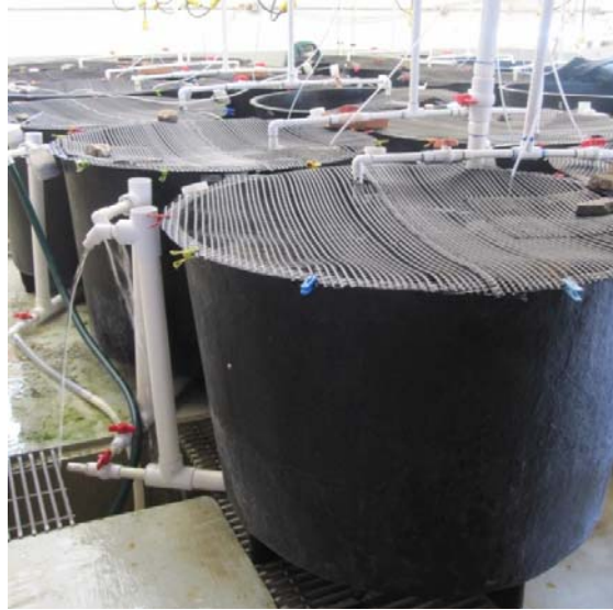
Figura 10. Tanques de fibra de vidrio de 600 litros utilizados durante la primera fase del experimento.
