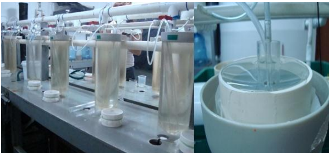
Figura 7. Sistema experimental para juveniles de 0 dpn recién nacidos de Hippocampus ingens . A la izquierda jarras eclosionadoras con sistema de recirculación., A la derecha tuvo de PVC con malla de 200 µm adaptado en la parte superior de la jarra eclosionadora.
