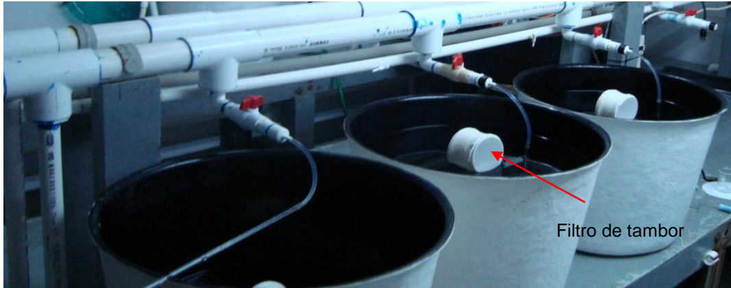
Figura 4. Sistema experimental para juveniles de 0 dpn de Hippocampus ingens con recirculación de agua y flujo de desagüe de filtro de tambor.
