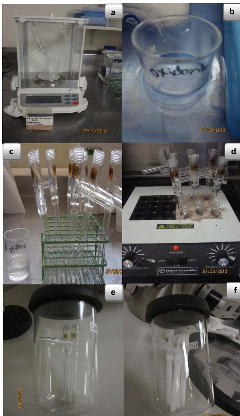
Figura 9. Oxidación de la muestra para determinación de cisteína: a) Peso de la muestra, b) Preparación de solución oxidante en baño frío, c) Adición de solución oxidante a las muestras, d) Oxidación de la muestra en baño seco, e) liofilización de las muestras oxidadas, f) Muestras liofilizadas listas para hidrolizarse.
