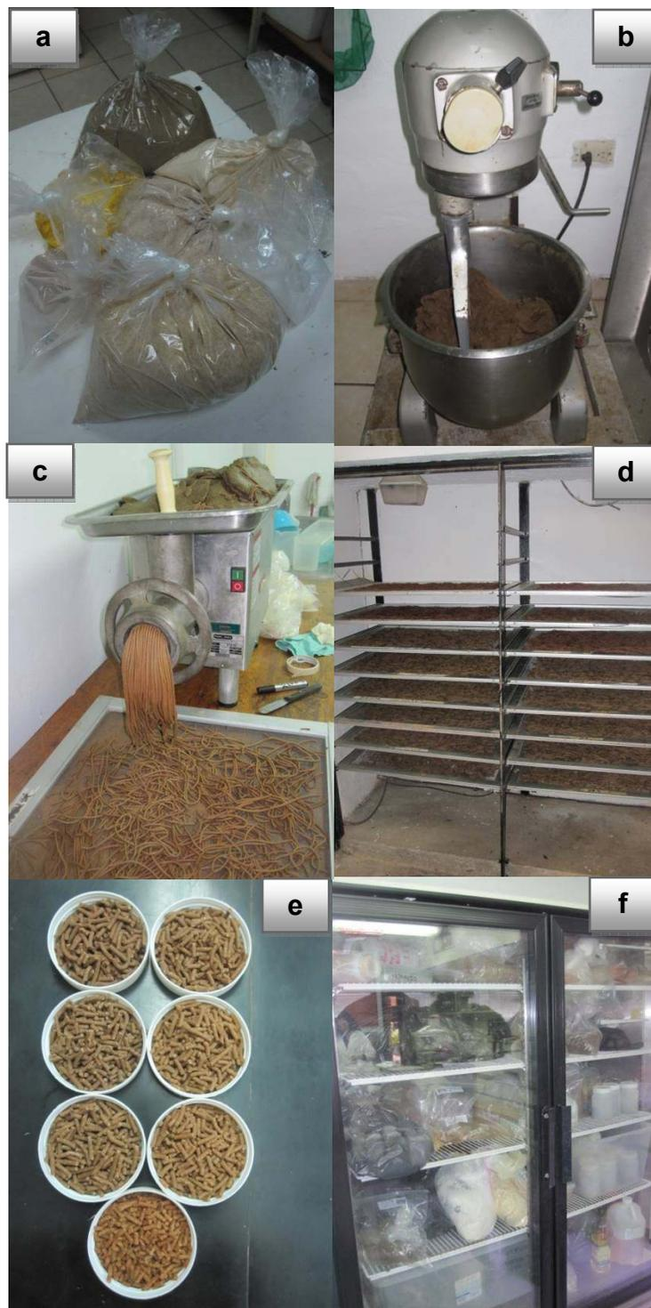
Figura 6. Elaboración de dietas experimentales: a) Ingredientes previamente pesados, listos para utilizarse, b) Homogenización de ingredientes, c) Peletizado de la mezcla homogénea, d) Alimento en desecador, e) alimento secado y peletizado, f) Almacenamiento en refrigeración.
