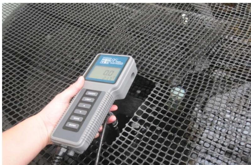
Figura 11. Medición de oxígeno y temperatura.
