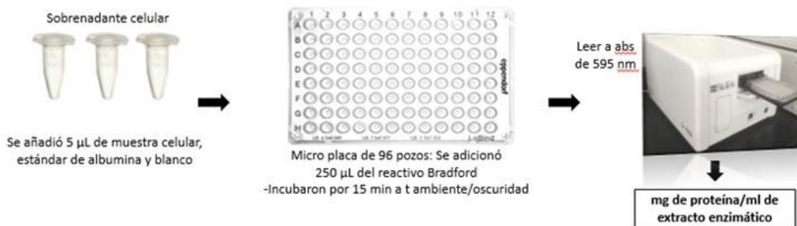
**Figura 12.** Diagrama propuesto para la cuantificación de proteína por el método Bradford.
