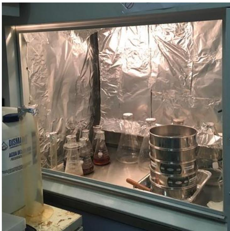
Figura 8. Campana que se utilizó como medio de aislamiento para el tamizado de muestras.
