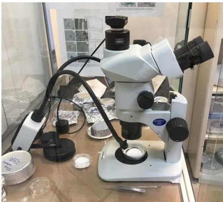
Figura 7. Microscopio estereoscópico Olympus SZX7 (70X) dentro de una cabina de cristal, utilizado para visualización y cuantificación de P-MPs.
