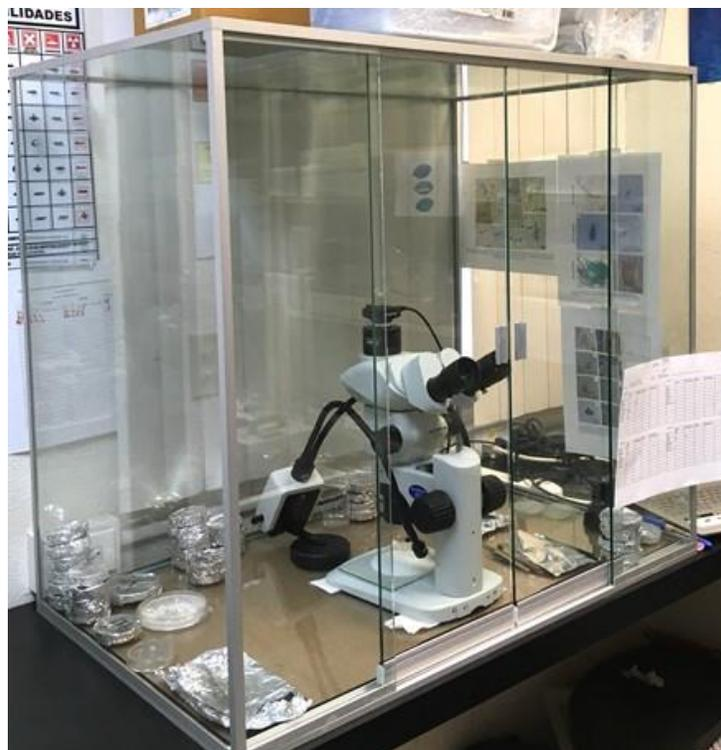
Figura 9. Cabina de cristal para evitar contaminación durante el proceso de visualización y cuantificación de partículas.
