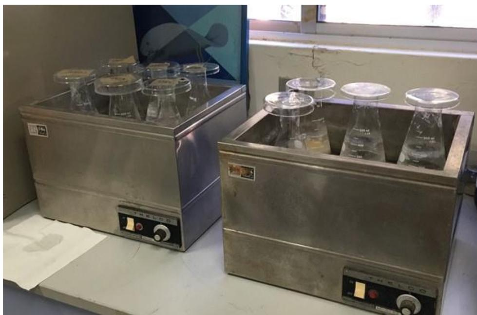
Figura 4. Muestras de heces en proceso de digestión en tinas baño maría en temperatura constante ( $45 \pm 5 \text{ }^\circ\text{C}$ ).
