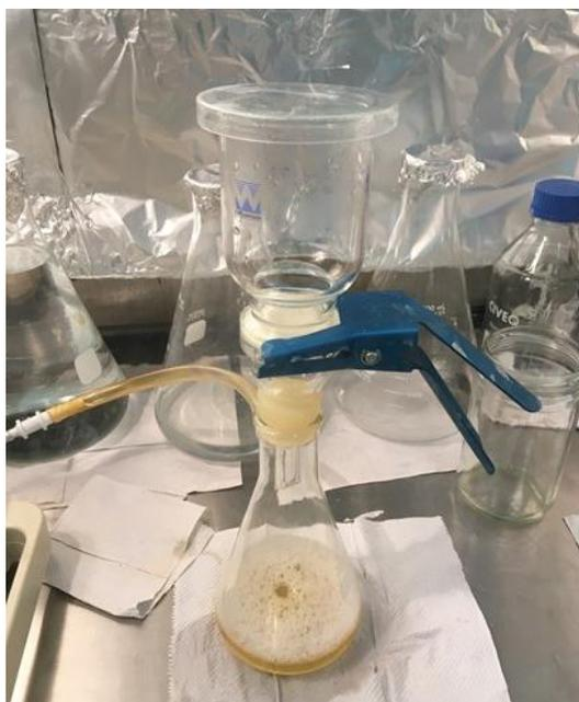
Figura 5. Muestra digerida en proceso de filtración utilizando una bomba de vacío.
