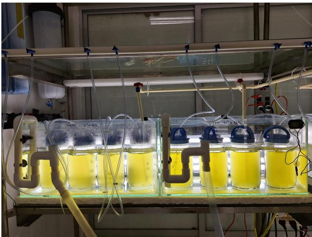
**Figura 4.-** Acuarios experimentales. Cada uno representaba un tratamiento con 4 unidades experimentales equipados con entradas y salidas de agua, calentadores automáticos, aireadores e iluminación compartida para controlar las condiciones del tratamiento.
