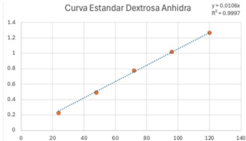
**Figura 11.-** Curva estándar de carbohidratos formada a partir de las absorbancias leídas en el espectrofotómetro a 485nm.
