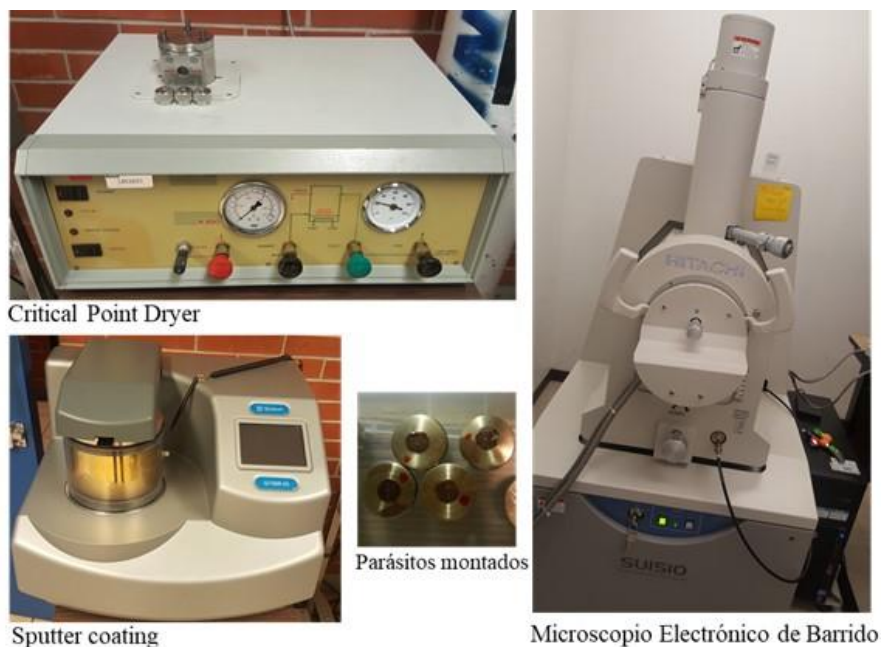
Figura 14. Equipos utilizados para la preparación de muestras de parásitos para observarse por microscopía electrónica de barrido.
