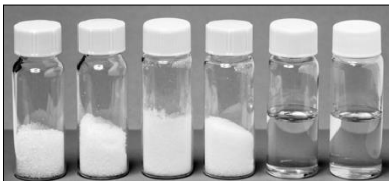
Figura 9. Formación de los DES (Daivan et al. , 2013) donde los dos primeros viales muestran el HBA (ChCl) y el HBD (urea), mientras que los dos últimos muestran líquidos (DES) resultantes de la asociación de ambos compuestos.
