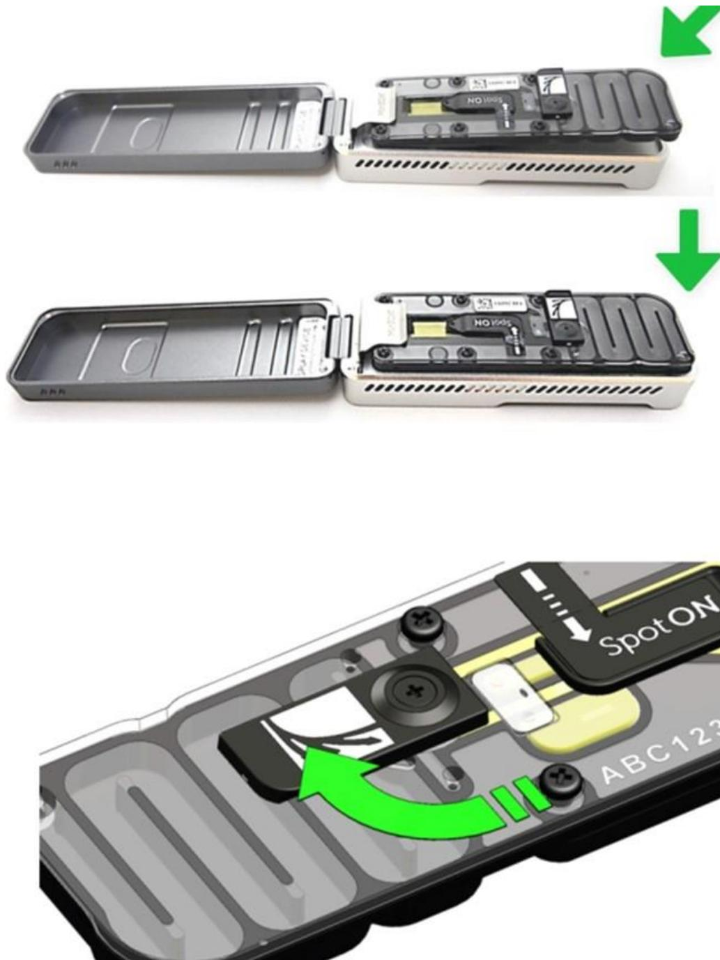
3.- Colocar una pipeta de 1000 µl en 200 µl, insertar la punta en el priming port, gira el volumen de la pipeta hasta que esté en 230 µl para retirar un pequeño volumen de buffer
