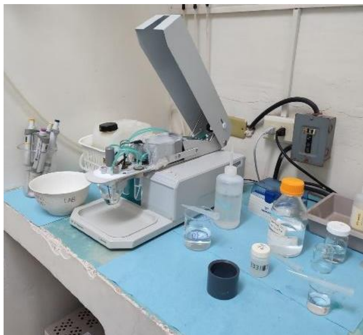
Figura 8. Equipo de voltamperometría de redisolución anódica 797 VA Computrace, Methrom®. Foto Isai Barba Acuña.
