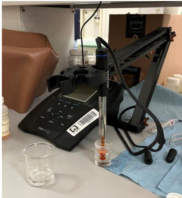
**Figura 7.** Potenciómetro Thermo Scientific™ Orion™ Star A211 utilizado para medir el pH en las muestras de agua.
