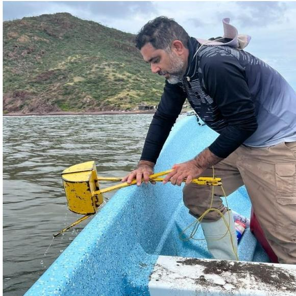
**Figura 5.** Toma de muestra de sedimento con draga Van Veen en Zona Costera (septiembre 2022).
