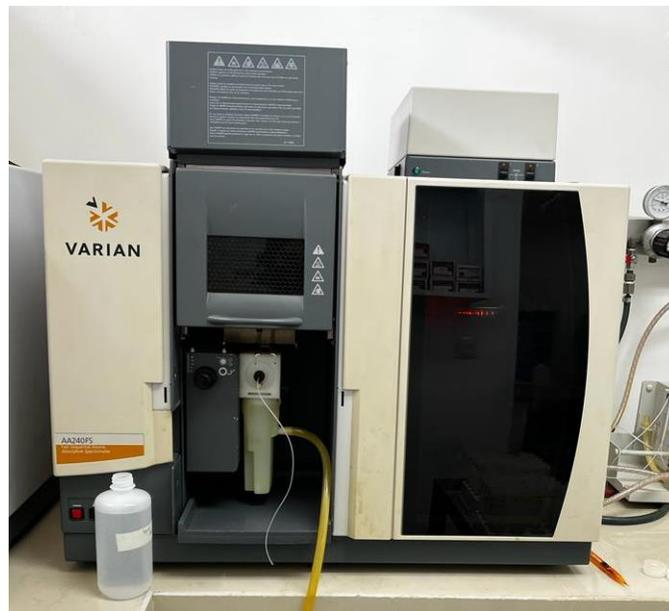
Figura 10. Espectrofotómetro de Absorción Atómica por flama Varían modelo Spectr AA 240FS utilizado para la cuantificación de la concentración biodisponible de los metales.
