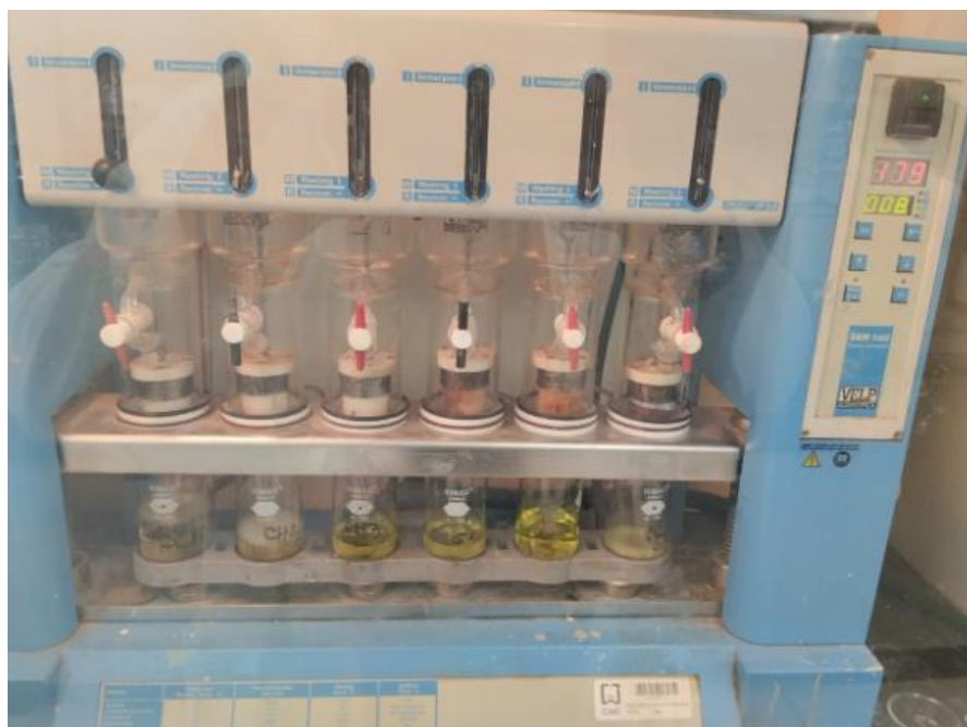
Figura 5. Equipo de recolección de hexano y recuperador de lípidos.
