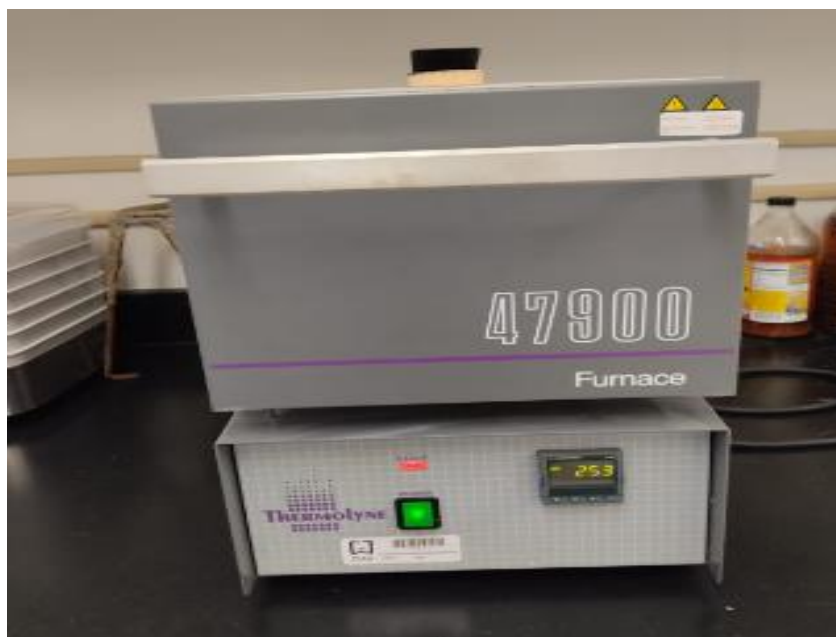
Figura 7. Horno mufla (47900 Fumance) utilizado para obtención de los valores de ceniza de los propóleos.
