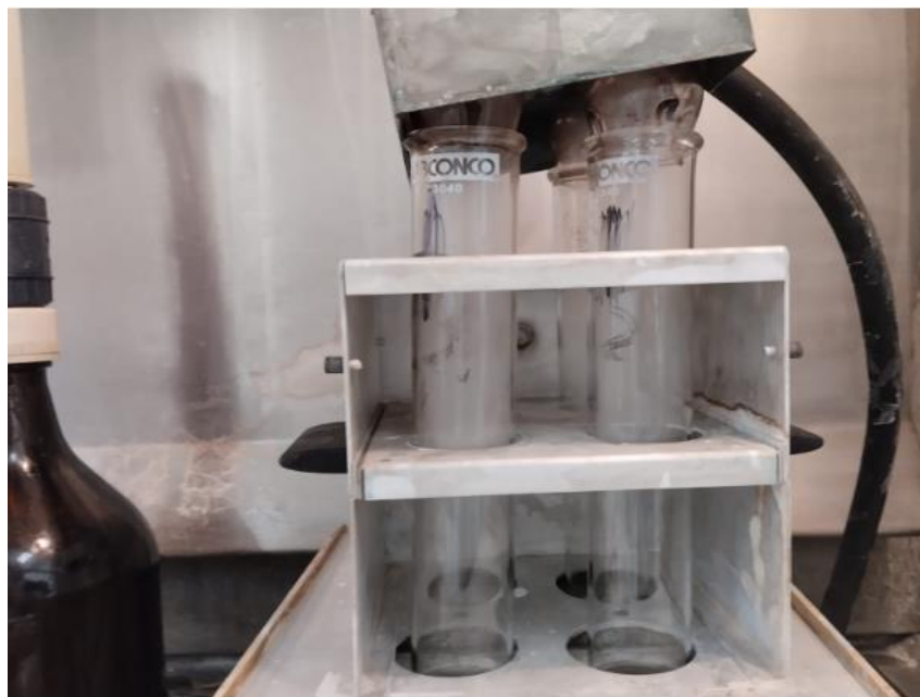
Figura 6. Unidad de digestión, aparato Kjeldahl utilizada para medir el contenido de proteínas presentes en los propóleos.
