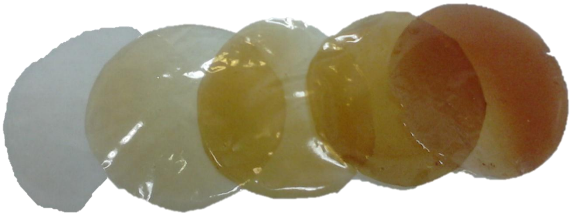
Figura 17. Películas desarrolladas con diferentes concentraciones de té verde (de menor a mayor concentración de izquierda a derecha).
