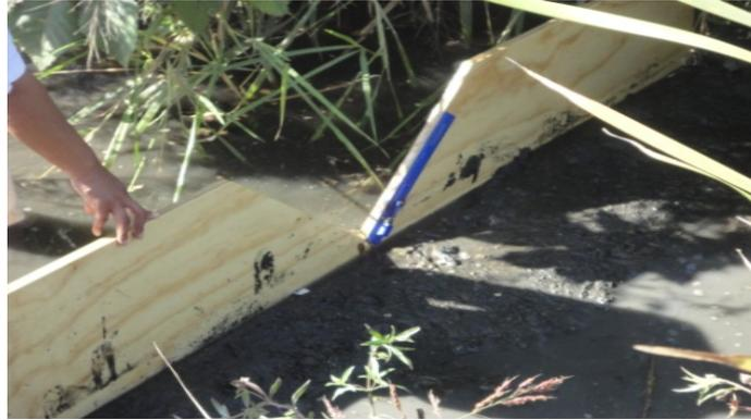
**Figura 4.** Método del vertedor triangular con un ángulo (90°).
