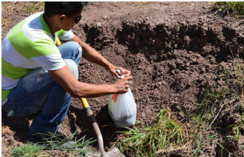
Figura 15. Toma de muestra para el estudio de mecánica de suelos.
