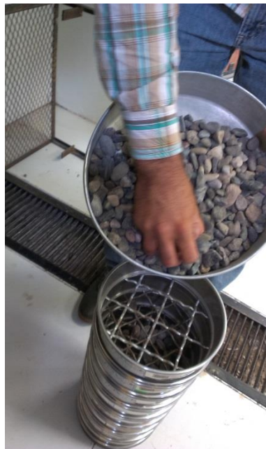
Figura 14. Tamizado de la grava para medir tamaño de partícula
